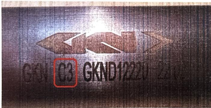
ПВ вузли: лазерне маркування GKN + шеврон + код заводу **C3** + номер запчастини.
